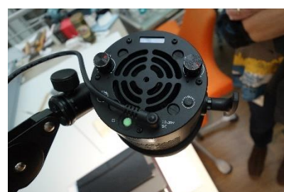
圖 2- 26 哈佛美術館修復室的全色用燈具，可調節色溫與聚光程度。
