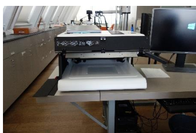
圖 2- 25 哈佛美術館修復室的高階檔案掃描器，其同時具備正常光、紅外光與紫外光。
