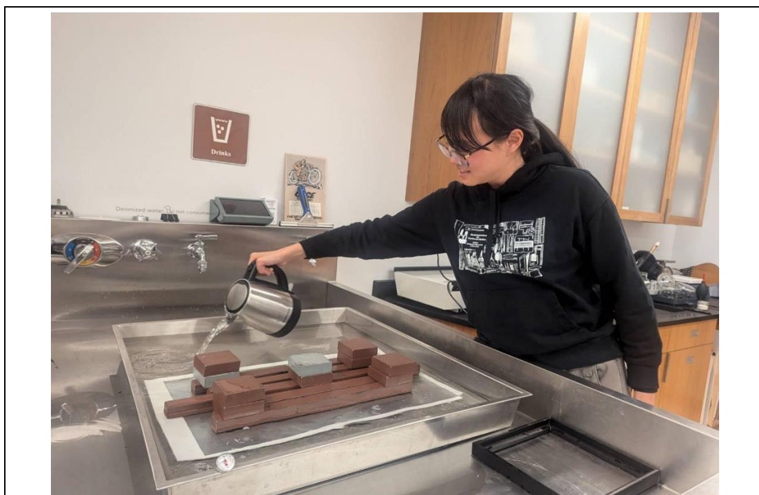
圖3為新作展覽中變形 3D 之列印板進行水浴法處理。
