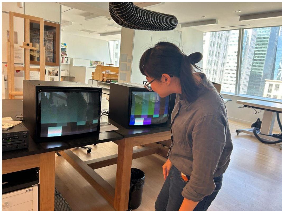
圖2 為新進映像管電視設備做色彩校正。
