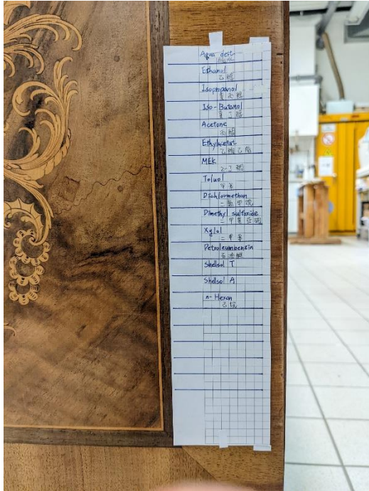
溶劑測試區域及使用溶劑種類
